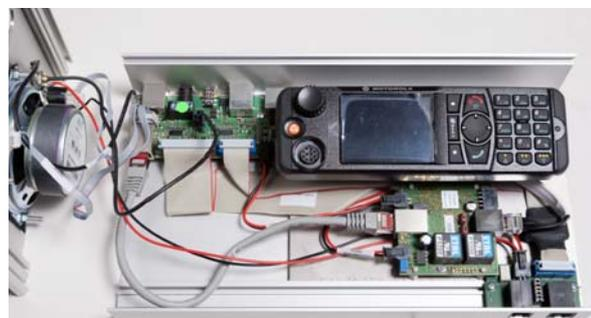
*Abb. 3-15 Gehäuse öffnen und Kabelbaum beachten*
